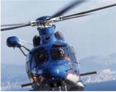
Лопастей вертолетов отбалансированы с помощью компонентов из сплавов DENSIMET® и INERMET®. Фото: Eurocopter
